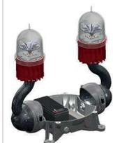
Balise montée sur un boîtier ZAMAC en aluminium équipé de deux cannes amovibles pour plus de flexibilité lors de l'installation, et d'un kit batterie pouvant offrir jusqu'à 12 heures d'autonomie. Presse étoupe et bornier inclus.
